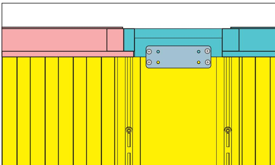
Skruva fast fästblecken mellan främre tak och vägg.
