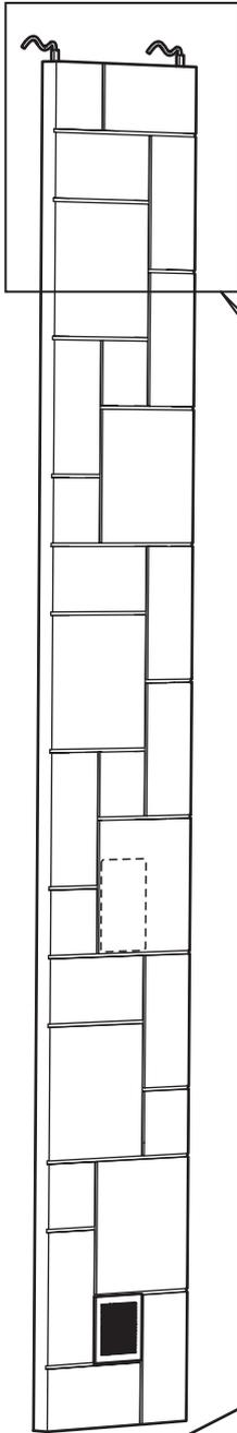
Sensorn till aggregatet placeras på den väggportal som är närmast aggregatet.
