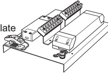
Trafoplåten placeras på valfri sida av takportalen, med fördel där den är lättast att komma åt för inkoppling.
