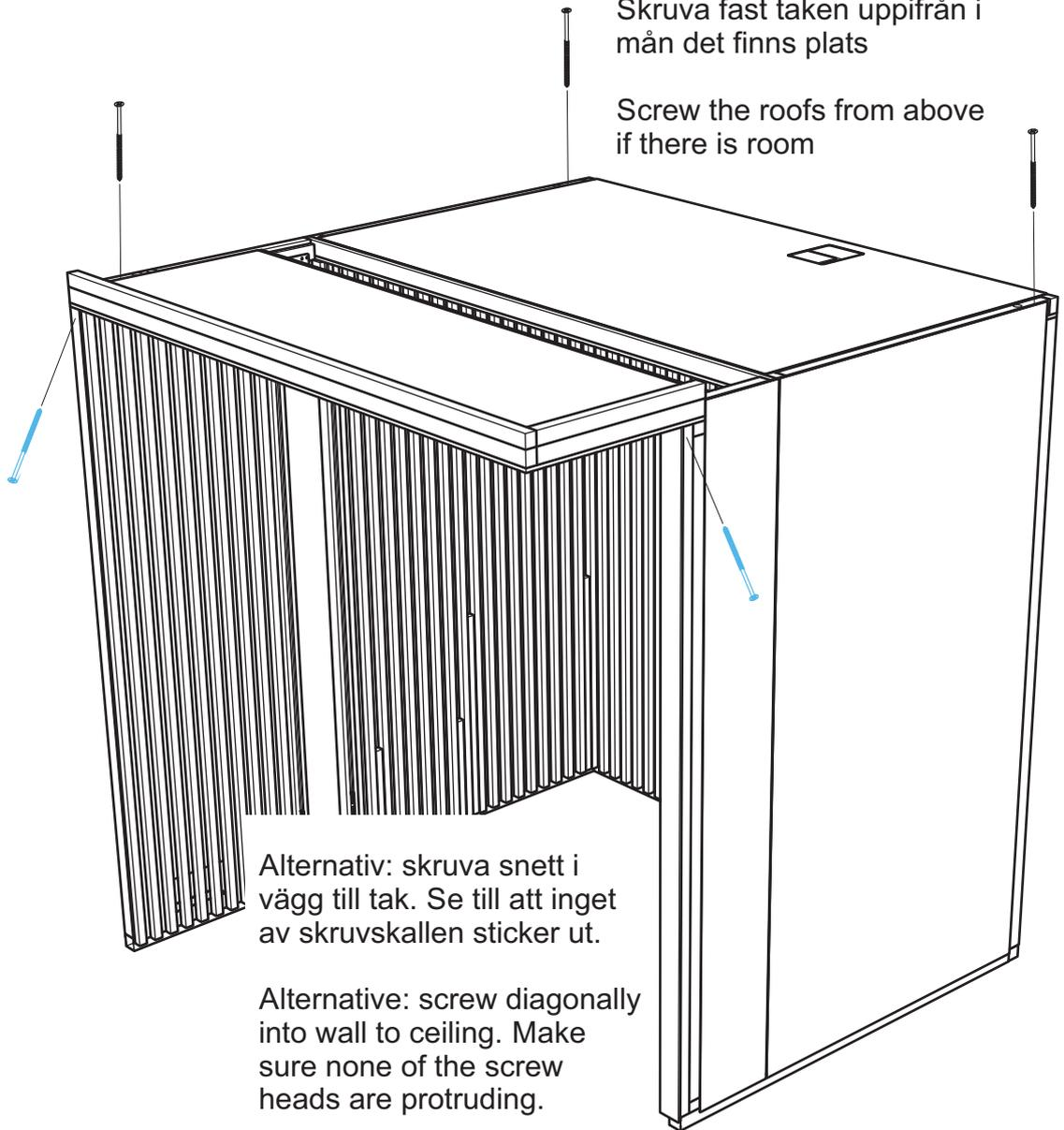
Alternativ: skruva snett i vägg till tak. Se till att inget av skruvskallen sticker ut.
