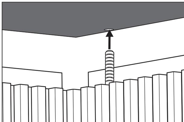
Se till att styra flexrören i de bakre sidoväggarna för belysning genom hålen i taket.
