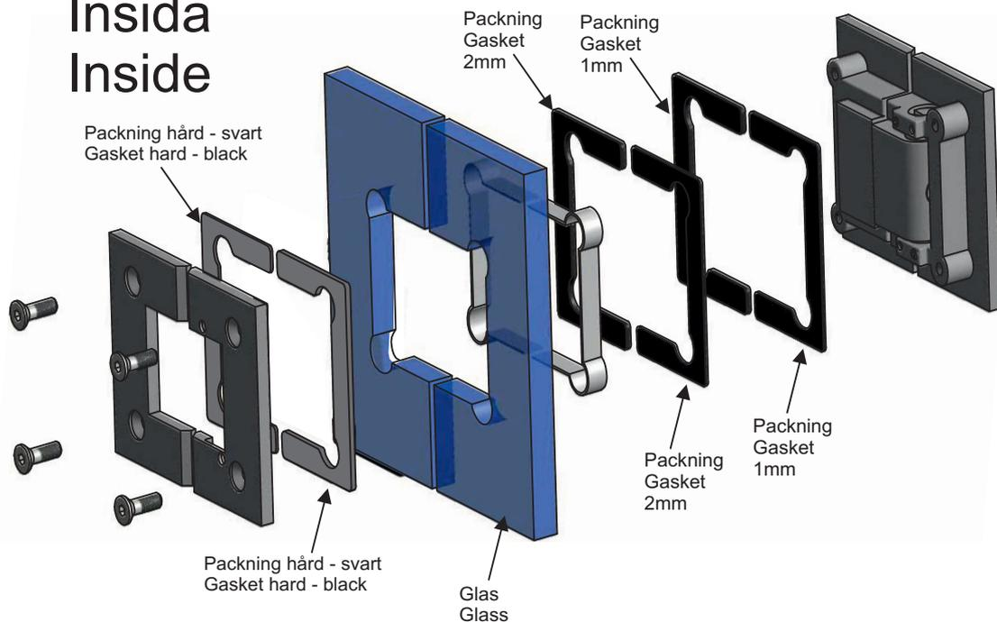
Lägg till fler packningar vid behov för att säkerställa att skruvarna drar fast tillräckligt.
