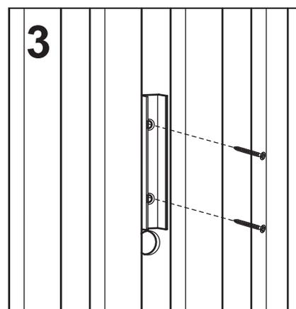
Håll U-profilen mot övre kanten på hålet och se till att den är centrerad mellan ribborna på väggen. Rita märke enligt bild. Borra hål och skruva upp profilerna på båda sidor av rummet.
