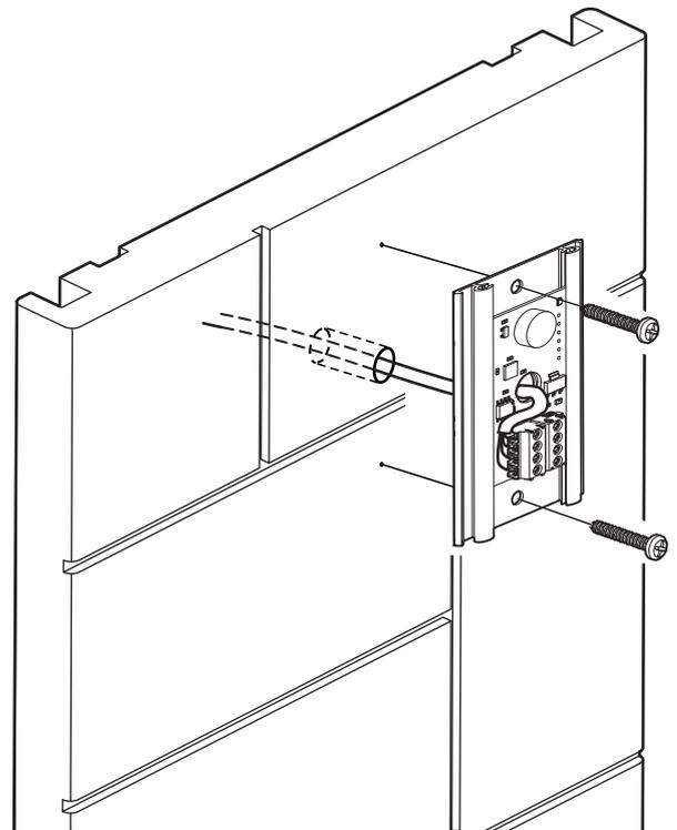
Ledningsdragning genom portal för fukt/tempsensor.
