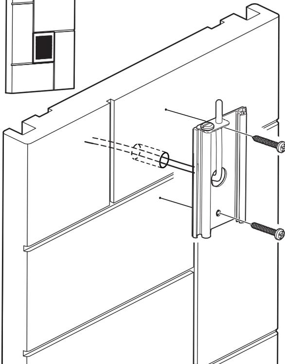
Ledningsdragning genom portal för tempsensor.
