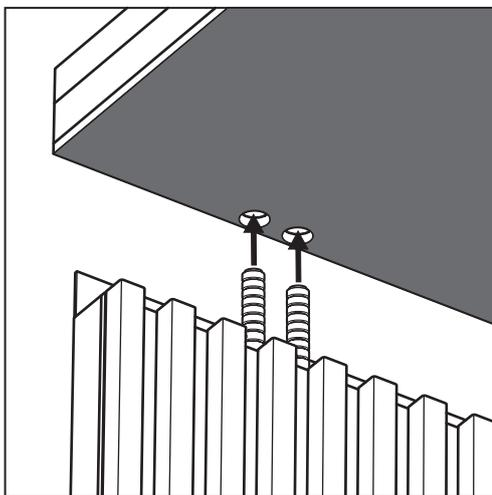
Se till att styra flexrören i de främre sidoväggarna för eldragning genom hålen i taket.
