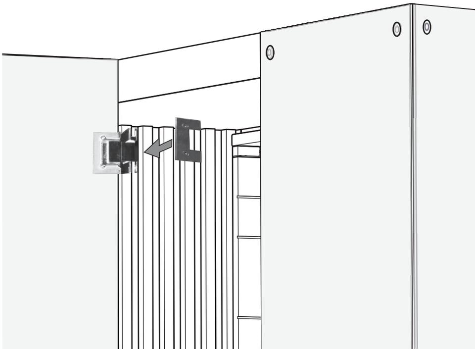
Lägg till packningar på gångjärnet och lyft glasdörren på plats i gångjärnen.
