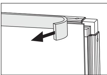
Entfernen Sie den Kantenschutz, sobald die Wand montiert ist.
