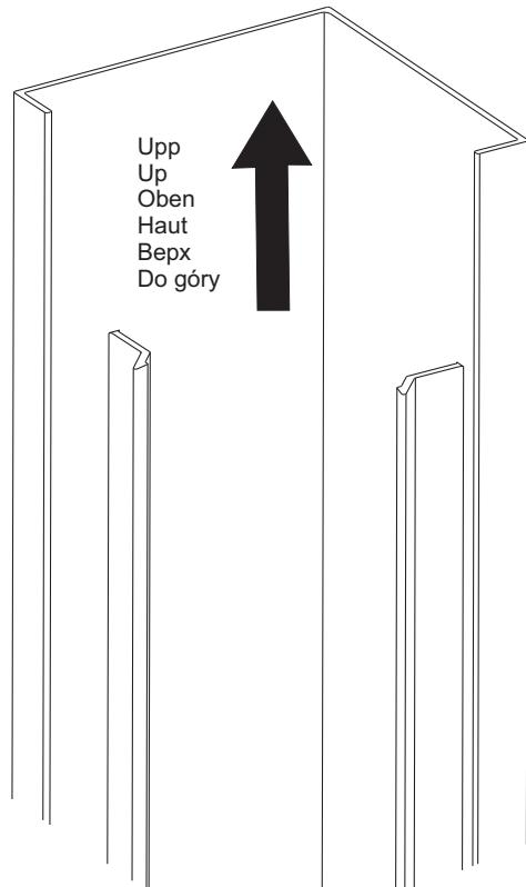
Banka med handen i hörnet på hörnprofilerna för att fästa dem.
