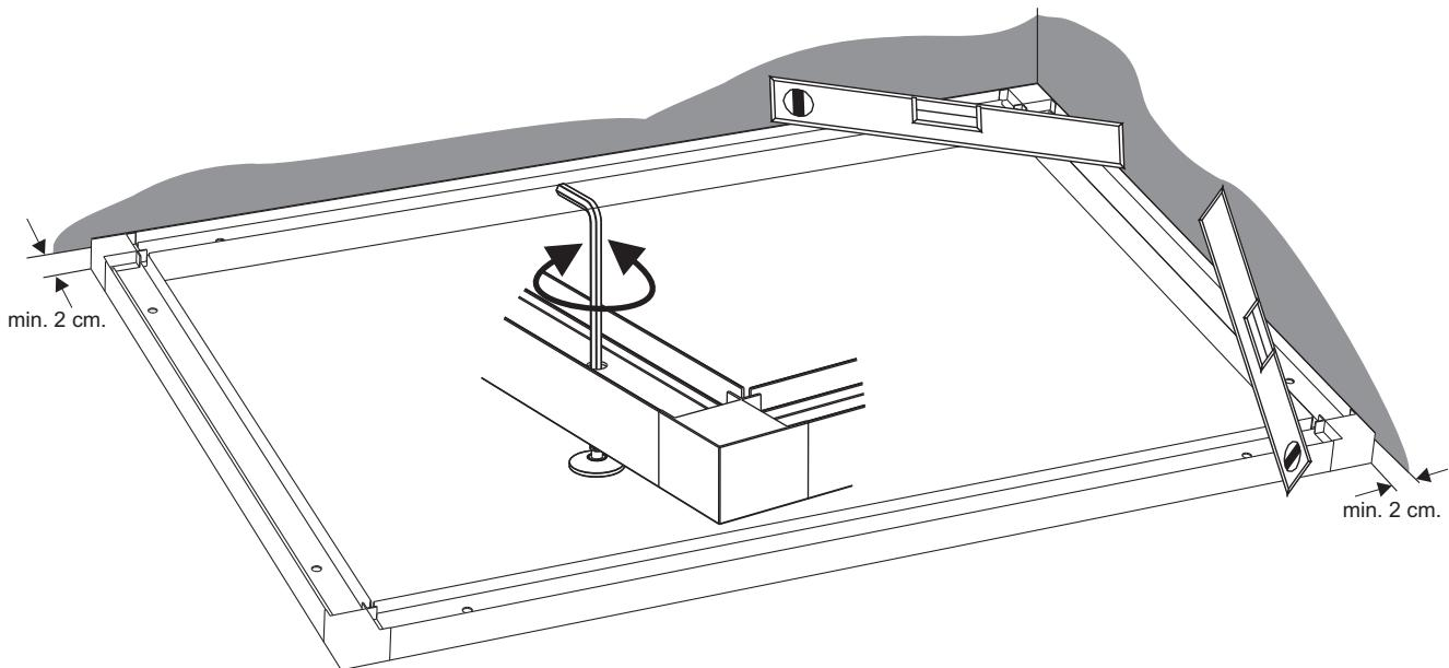
Placera golvramen där rummet ska stå. Kontrollera att ramen ligger plant, använd vattenpass. OBS! Det är ett absolut krav att golvramen ligger plant "i väg" för att slutresultatet ska bli perfekt. Justera ställfötterna med insexfnyckeln. Det är viktigt att ställfoten hamnar under ytan där väggarna ska stå.
