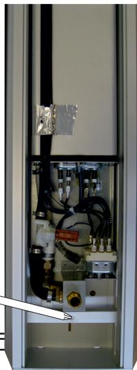
För in en skravmejsel under pelaren så att den ligger tryckt mot taket. Skruva sedan fast pelaren nedtill.
