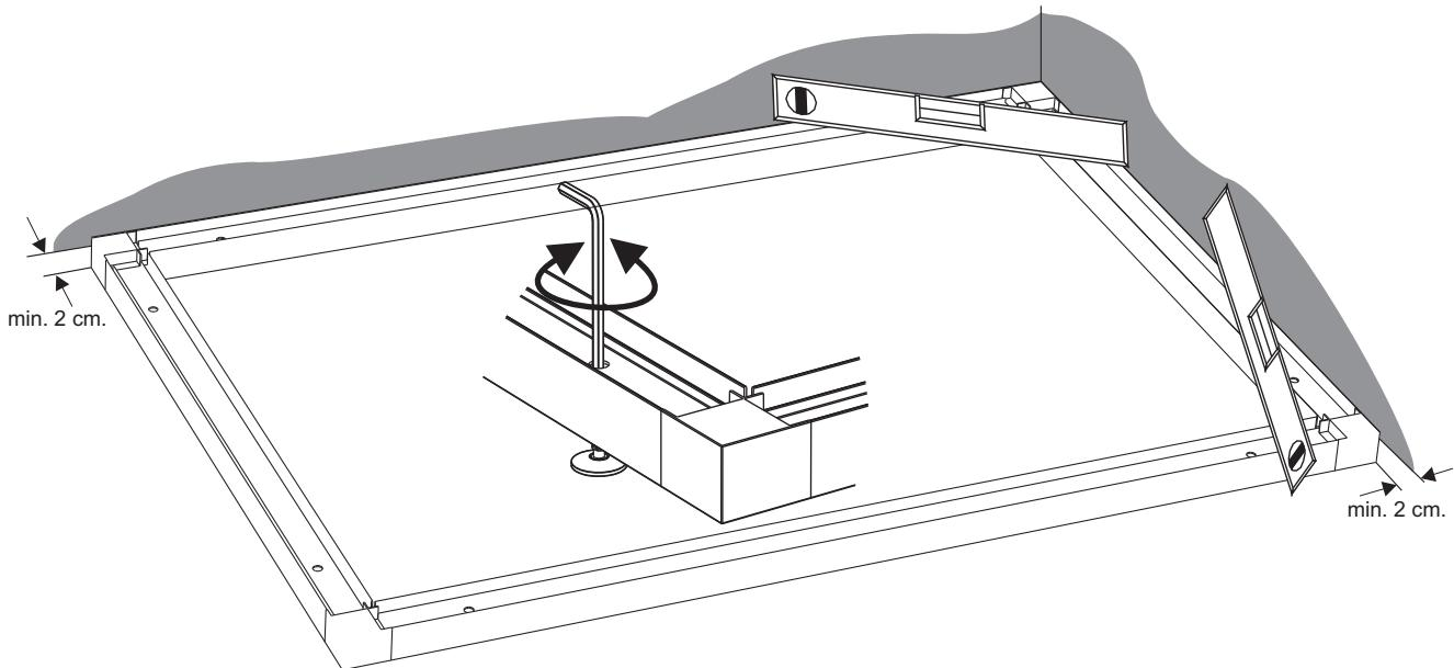
Placera golvramen där rummet ska stå. Kontrollera att ramen ligger plant, använd vattenpass. OBS! Det är ett absolut krav att golvramen ligger plant "i våg" för att slutresultatet ska bli perfekt. Justera ställfötterna med inseknyckeln. Det är viktigt att ställfoten hamnar under ytan där väggarna ska stå.
