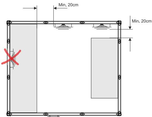
*Älä aseta sisustuselementtejä tai muita esineitä suoraan höyrysulakkeen eteen tai yläpuolelle. Höyrysulakkeen edessä on oltava vähintään 20 cm:n vapaa tila, ks. kuva.*
