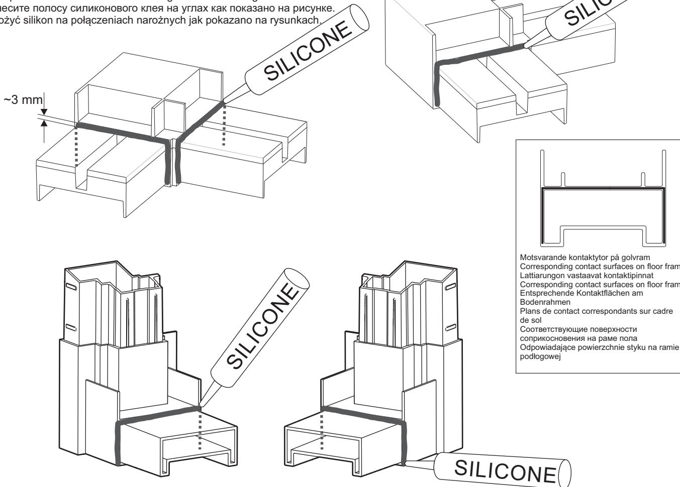
Skjut in hörnknutarna i golvramsprofilerna
