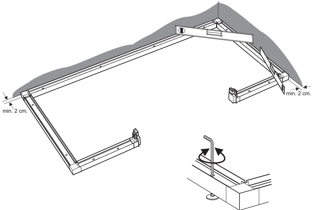
Placera golvramen där rummet ska stå. Kontrollera att ramen ligger plant, använd vattenpass. OBS! Det är ett absolut krav att golvramen ligger plant "i väg" för att slutresultatet ska bli perfekt. Justera ställfötterna med insexfnyckeln. Det är viktigt att ställfoten hamnar under ytan där väggarna ska stå.
