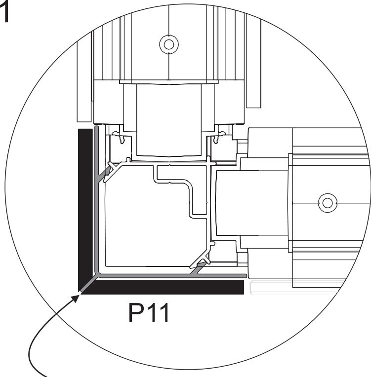
Banka med handen i hörnet på hörnprofilerna för att fästa dem.
