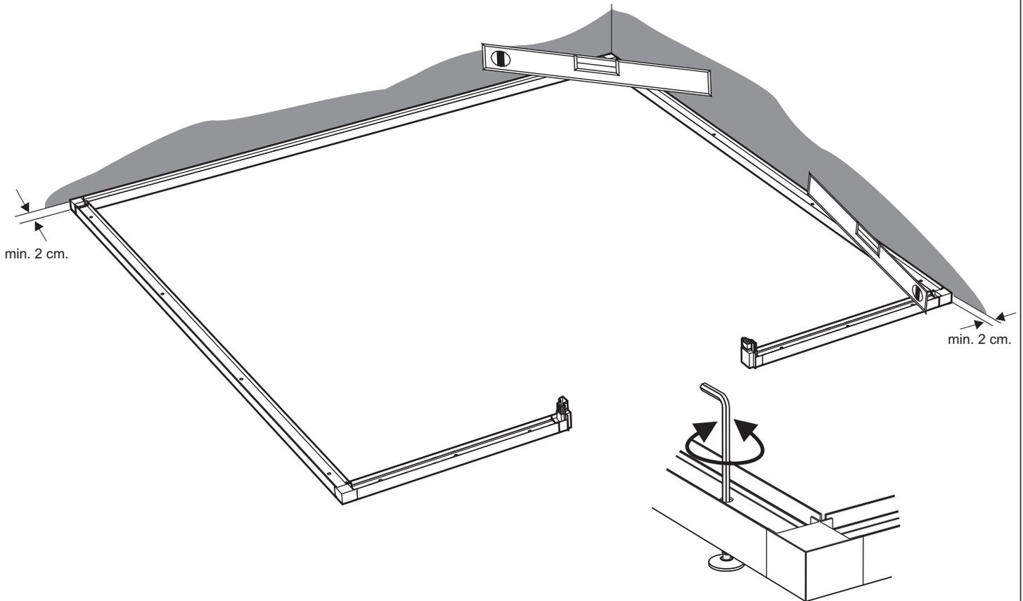
Placera golvrmen där rummet ska stå. Kontrollera att ramen ligger plant, använd vattenpass. OBS! Det är ett absolut krav att golvrmen ligger plant "i våg" för att slutresultatet ska bli perfekt. Justera ställfötterna med insexnyckeln. Det är viktigt att ställfoten hamnar under ytan där väggarna ska stå.
